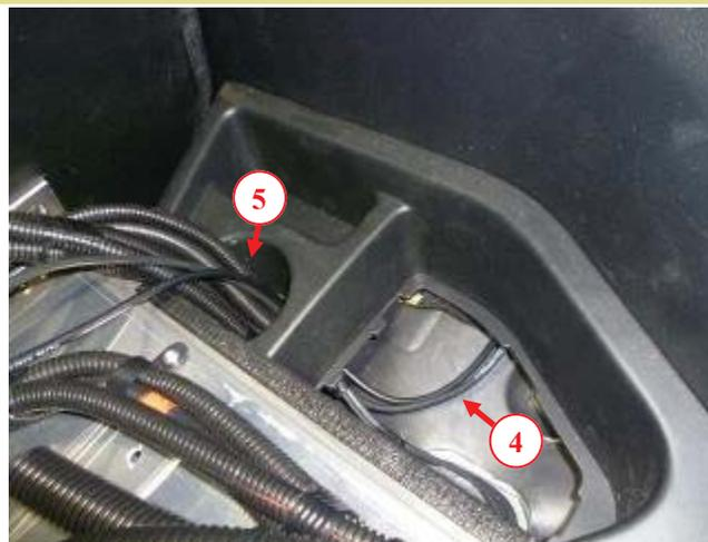
4. Les deux câbles d'antenne passent par ce chemin et sortent par le trou 5 pour se rendre sur le tiroir droit du plateau.
