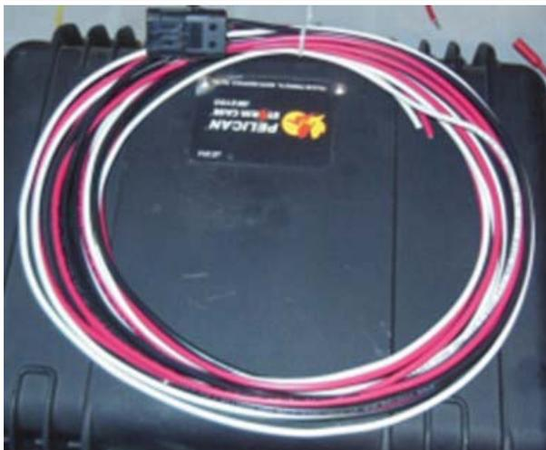
Ce câble doit-être inséré dans un tube de plastique (LOOM) entre la valise RTD et le dessus du tiroir des équipements radio.
