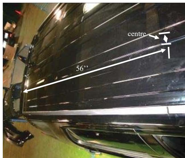
**Perçage du trou pour le câblage du gyrophare et de la flèche zone :**
