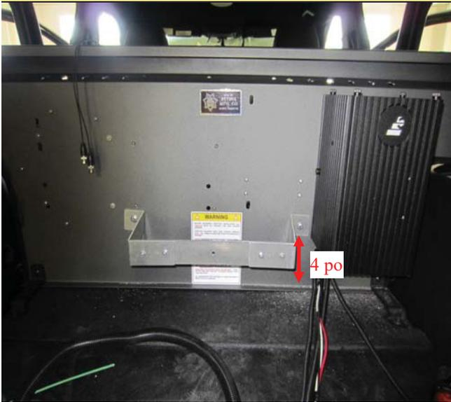
Utiliser 2 boulons M6 de 19 mm (1/4 X 3/4) équipés de rondelles métallique et écrous autobloquant
