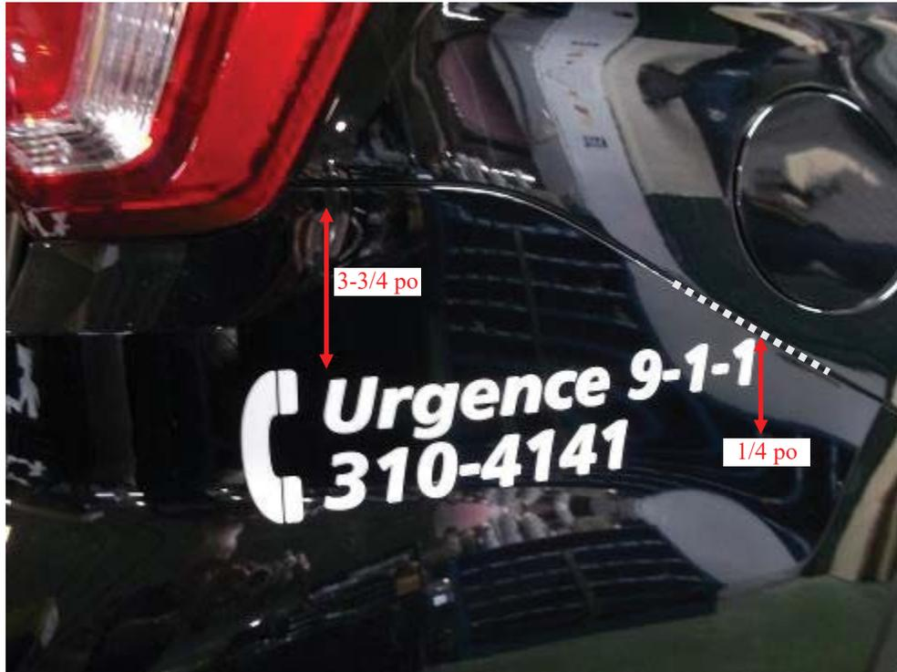
Apposer le mot URGENCE côté droit arrière du pare-chocs à partir de la lentille 3-3/4 po et le dernier 1 du 9-1-1 à 1/4 po du joint de pare-chocs.
