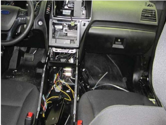
Brancher le fil jaune provenant de la minuterie RTD à un porte fusible ATO à l'aide d'un union thermo jaune et brancher le porte fusible à l'ignition du véhicule.
