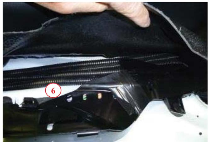
1. Attacher les 2 câbles sur le filage d'origine du véhicule côté droit sur le « kick pad ».
