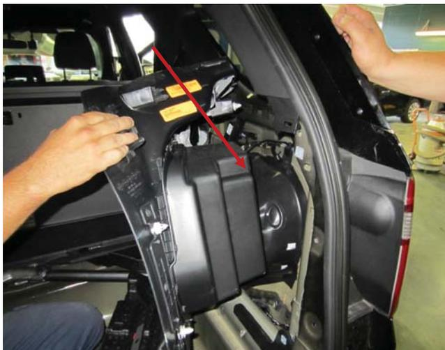
Retirer la garniture arrière et acheminer le câble de l'antenne GPS vers le pilier C avec les autres câbles d'antenne.
