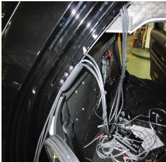
Descendre les câbles d'antenne le long du pilier C droit (côté passager) jusqu'à l'intérieur de la moulure.
