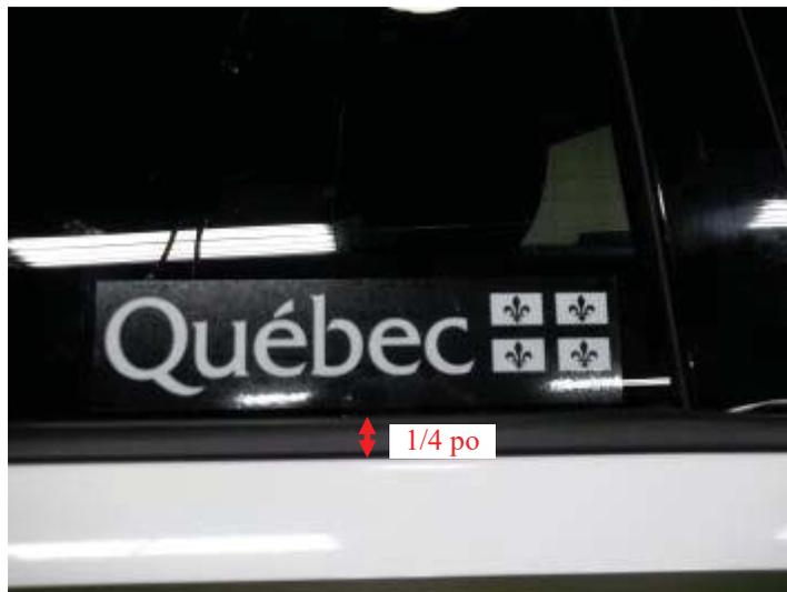
La signature doit être apposer à 1/4 po en haut de la garniture de caoutchouc et à 10 po à partir de l'arrière de la fenêtre.
