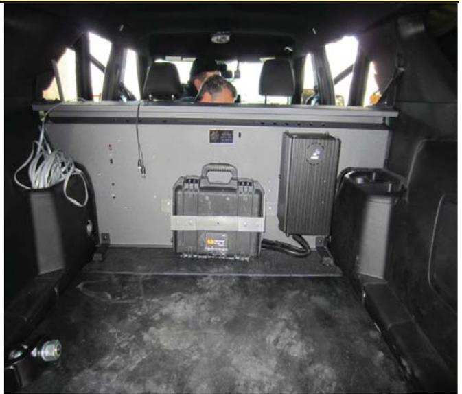
Fixer le support de retenu pour la valise RTD au centre de la cloison à une hauteur de 4 po du plancher tel qu'indiqué
