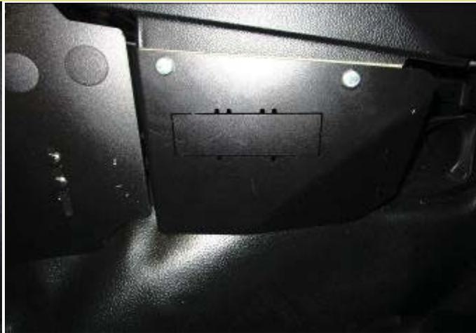
Lorsque le montage de la console véhiculaire, du système RTD et du câblage de la radio sera terminé, vous pourrez installer les panneaux latéral droit et gauche de chaque côté avec 2 boulons 1/4NC X 3/4 po.
