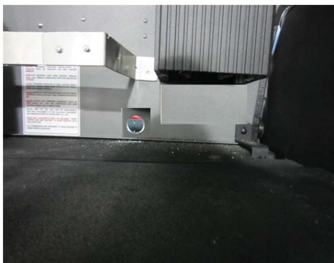
Acheminer les câbles des antennes RTD et GPS vers l'arrière du véhicule en utilisant le même trou que pour les autres câbles provenant de la console et de la plaque de branchement.
