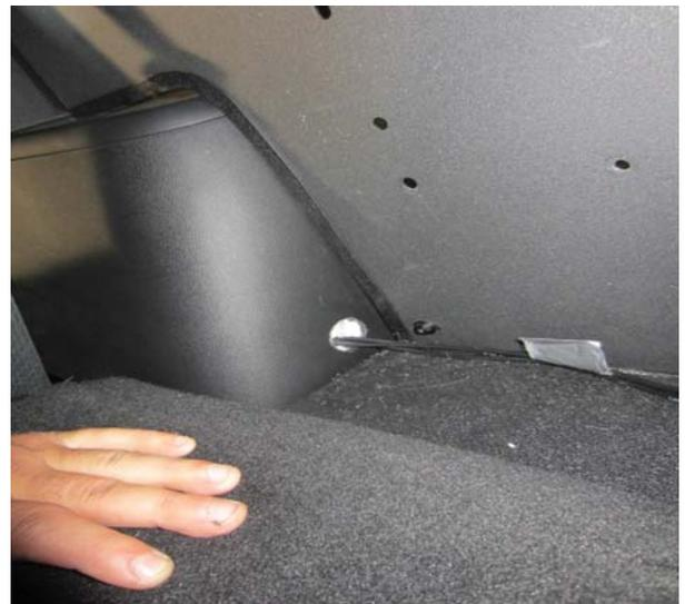
Percer un trou de 1 1/4 po dans la moulure côté passager tel qu'indiqué et passé les 2 câbles.
